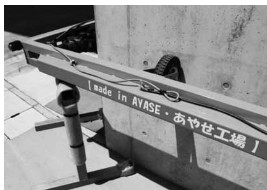
綾瀬大橋に取り付けたインフラ点検ロボット「のぼるくん」
